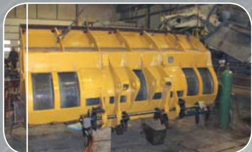
Soudage et alésage des portées d'axe sur divers godets
