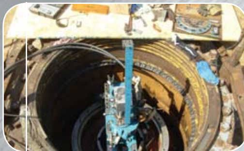
Alésage d'une portée de bague de 18 po de diamètre sur un concasseur Simons
