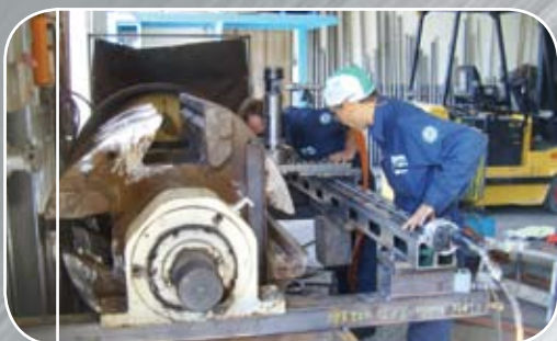
Fraisage des portées d'assise de marteaux sur un concasseur rotatif
