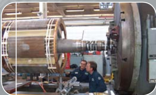
Fraisage d'une portée sur un arbre de rotor
