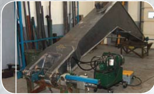
Alésage complet après l'assemblage d'une flèche articulée
