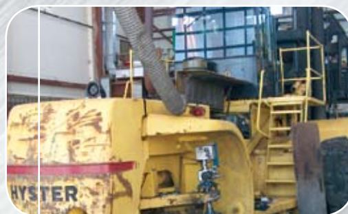
Alésage de portées d'axe de direction sur un chariot élévateur Hyster
