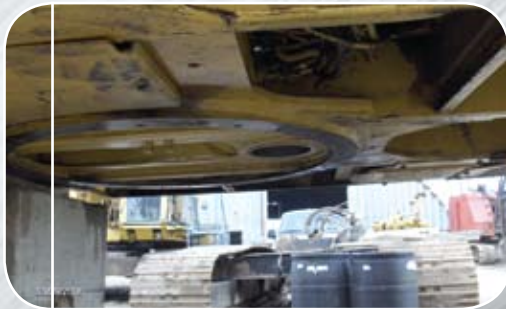
Resurfaçage d'assise d'un coussinet de 60 po de diamètre sur le pivot d'une pelle hydraulique
