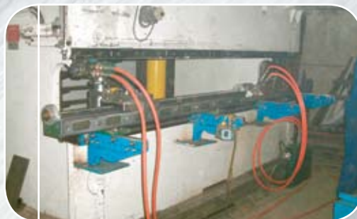
Rectification des sièges de matrice sur une plieuse de 15 pi
