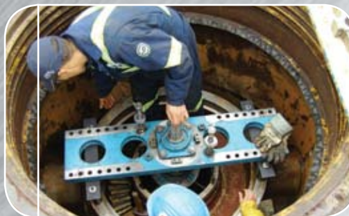
Montage pour aléser une portée de bague de 16 po de diamètre par 36 po de long sur un concasseur rotatif
