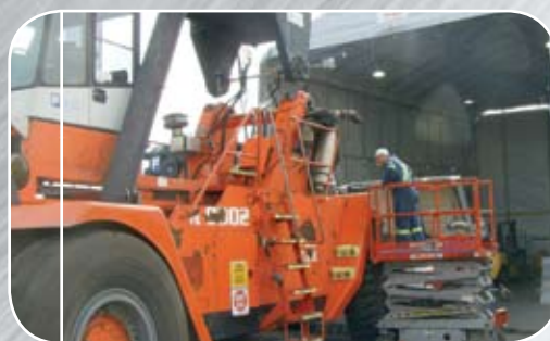
Alésage des portées d'arbre pour le support de la flèche sur un chariot élévateur de conteneurs
