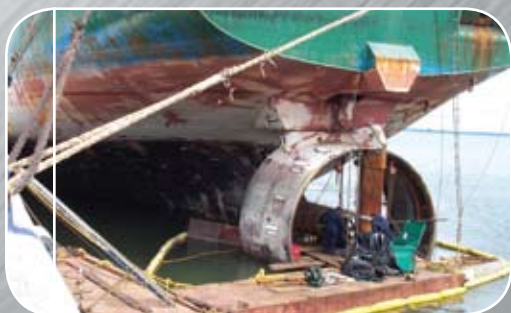
Resurfaçage des portées de l'arbre de l'hélice en bordure du quai
